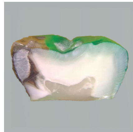
Figura 3. Imagen de un espécimen con puntaje de microfiltración = 4 (grupo 2, Papacárie + Ketac Molar Easymix®).
